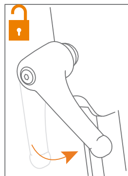
Figure 43: Desserrez les poignées de réglages.
