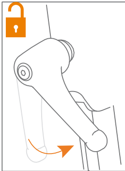
Figure 20: Tournez dans le sens inverse des aiguilles d'une montre.
