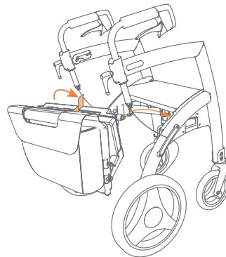
Abbildung 37: Anbringen des Rollstuhlpakets.
