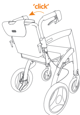
Figure 42: Encliquez le dossier dans les rails de guidage.
